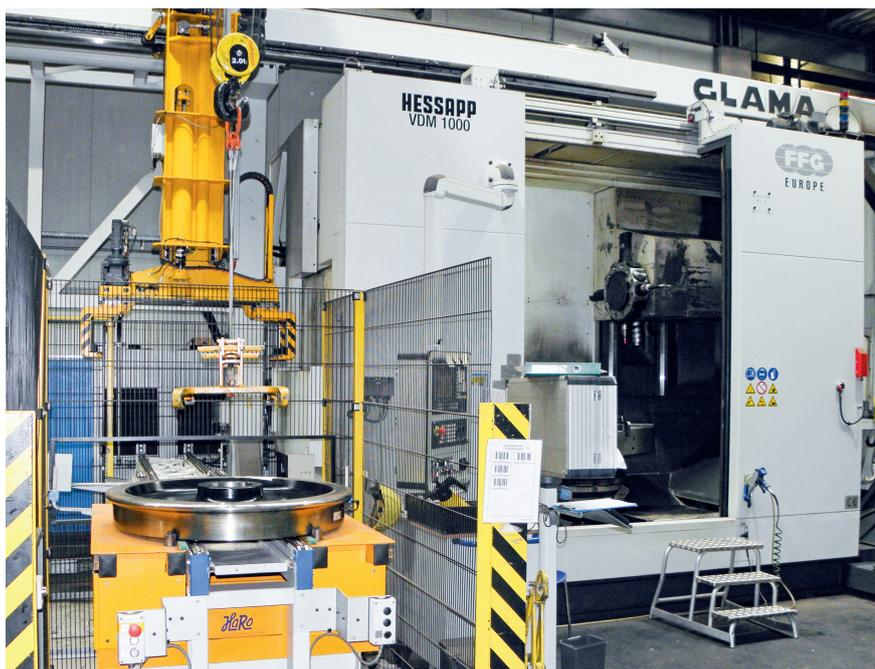
3 Die Radnaben werden auf einer Vertikaldrehmaschine auf genaues Paarungsmaß zur Laufachse gedreht (©Hexagon)
