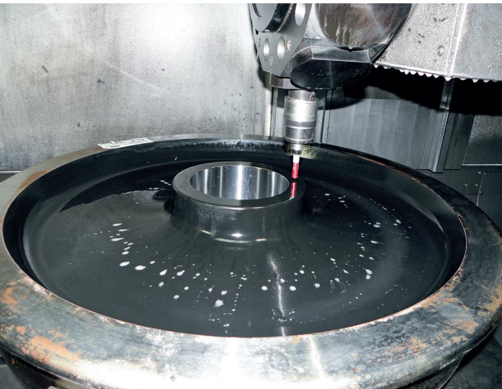
**1** Der Temperaturmesstaster von m&h erfasst in Sekundenschnelle die genaue Temperatur des Werkstücks und dokumentiert sie. Nur wenn der Wert stimmt, darf die Bearbeitung starten (© Hexagon)
