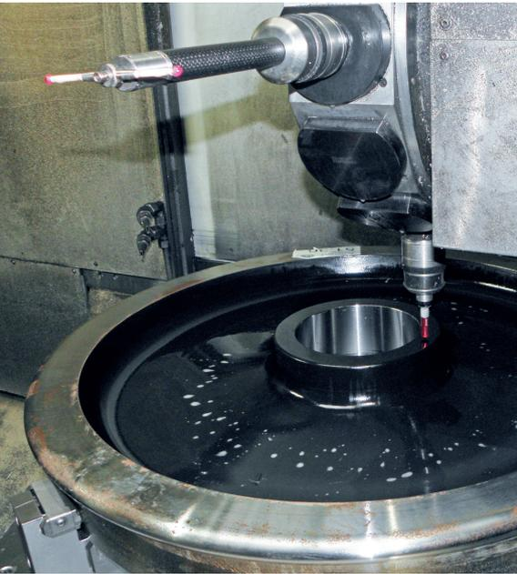
4 Das Einhalten des vorgeschriebenen Temperaturfensters wird mit dem Temperatur-Messtaster überprüft; der Messtaster mit Verlängerung wird zur Lagebestimmung der Nabenbohrung verwendet (© Hexagon)
