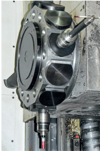
5 Temperatur-Messtaster und Messtaster mit Verlängerung und Tastkreuz von m&h werden im Revolver der Drehmaschine vorgehalten (© Hexagon)
